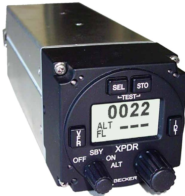
**Einblockgerät / Single Block Unit BXP 6401-X-(XX)**
